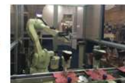
수작업에 의한 접착과정 + 제조용 로봇적용 → 로봇자동화 시스템의 접착과정
